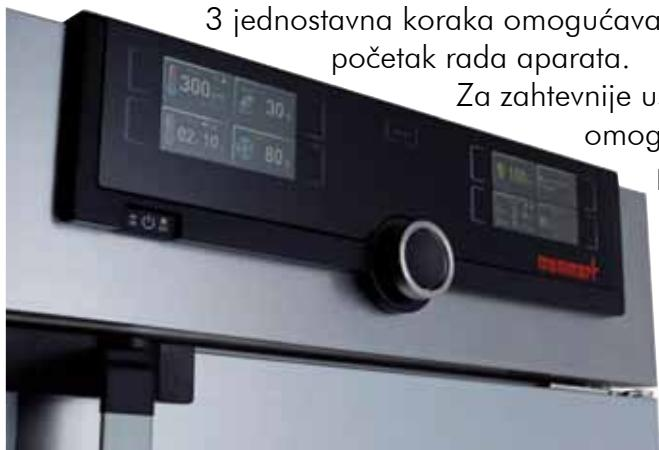
Za zahtevnije uslove rada i zadovoljavanje visokih standarda, omogućeno je svim cenjenim korisnicima proizvoda kompanije **Memmert**, touch screen-**TWIN DISPLAY**, koji pored mogućnosti da se u 3 jednostavna koraka podesi temperatura, brzina ventilatora, svetlo i omogućava memorisanje podataka do 10 godina, programiranje alarma, podešavanje programa koji je prethodno memorisan i pozivanje istog...
